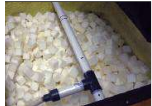
Milieu synthétique — cubes de mousse (vue de dessus)
